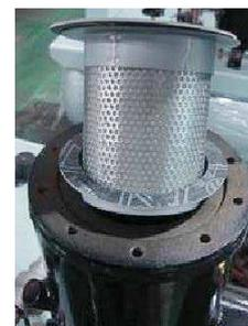
Рис. 12. Масляный сепаратор
