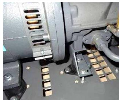
Рис. 7. Шокозащитный крепеж
