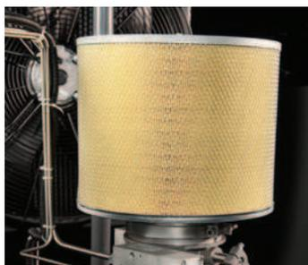
Рис. 11. Воздушный фильтроэлемент
