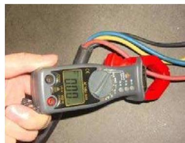
Рис. 15. Клещеобразный амперметр
