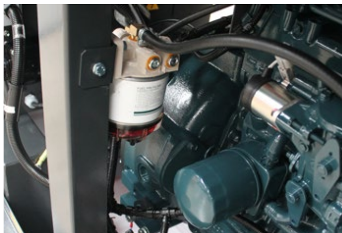
Топливный фильтр высокой степени фильтрации и возможностью слива
