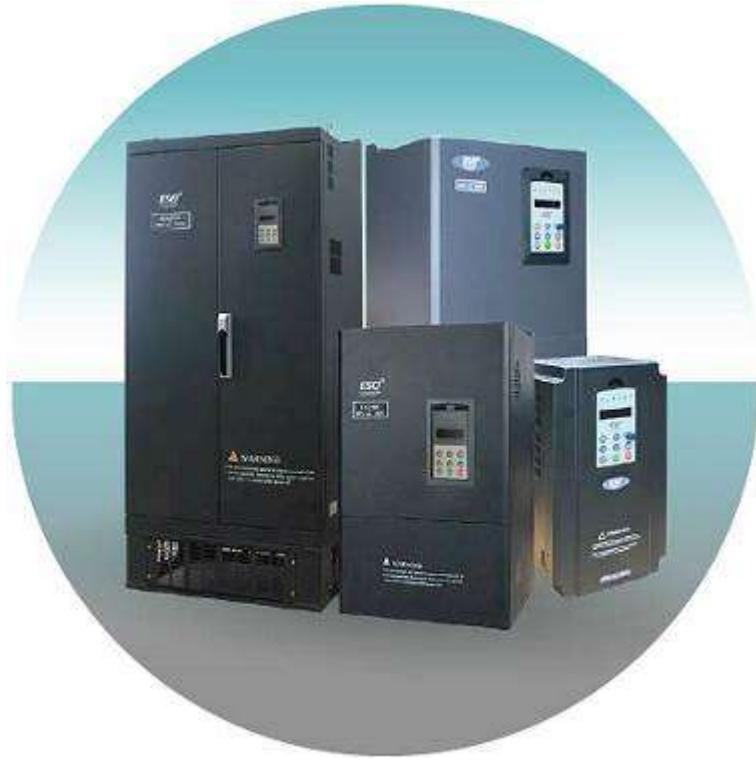
Преобразователь частоты представляет собой электронный блок управления, регулирующий скорость вращения электромотора путем модуляции подаваемого на него тока. Частотный преобразователь в винтовом компрессоре обеспечивает постоянный контроль, изменения скорость двигателя, чтобы четко следовать за потребностью в сжатом воздухе. Осуществляет полную защиту электродвигателя и позволяет проводить мониторинг всей системы в целом.
