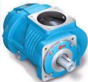
**Винтовой блок EVO9** производится фабрикой Rotorcomp (Германия) и является основой винтового компрессора. Визуально он представляет собой чугунный корпус, внутри которого на подшипниках размещены два ротора, сжимающие воздух.
